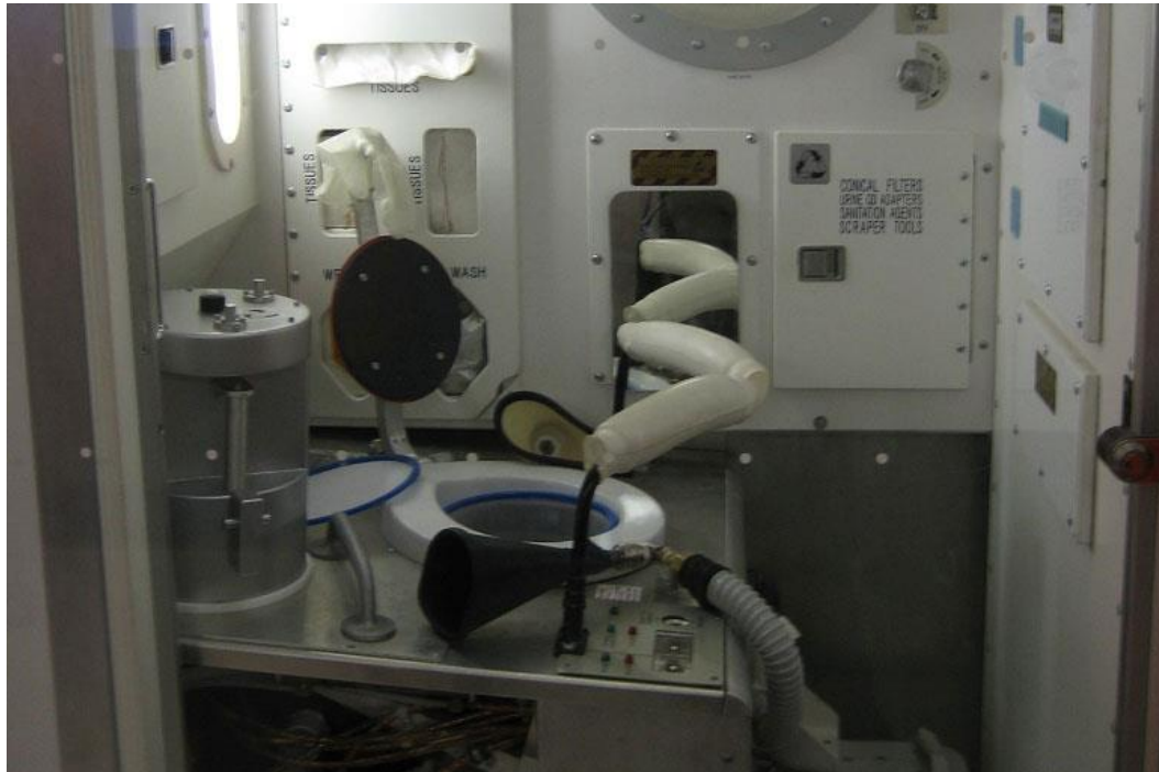
ภาพที่ 3.3.4 ภาพอุปกรณ์ขับถ่ายของมนุษย์อวกาศ
